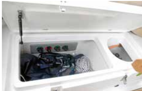
Backskiste an Backbord mit Hauptschalter und Fach für die Gasflasche, CE-konform mit Außenbelüftung.
