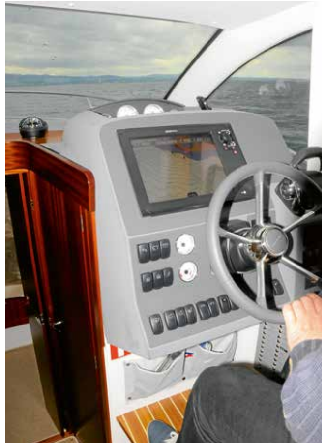
Steuerstand mit hochklappbarer Sitzfläche und verstellbarem Lenkrad.
