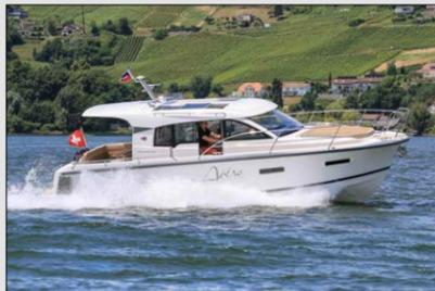
Um insgesamt bessere Fahreigenschaften in einem möglichst grossen Drehzahlbereich bieten zu können, erhielt die Nimbus 305 Coupé ein komplett neu konzipiertes Unterwasser. Hydrodynamische Optimierungen sorgen dafür, dass praktisch keine Gleitgrenze mehr spürbar ist. Ohne merkliches Aufkommen beschleunigt das Boot bis auf knapp 40 km/h. Zudem ist die 305 bei einer Marschgeschwindigkeit von rund 20 km/h erstaunlich sparsam unterwegs.
